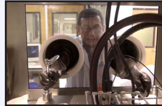
MOCVD Aixtron multi-wafer growth
